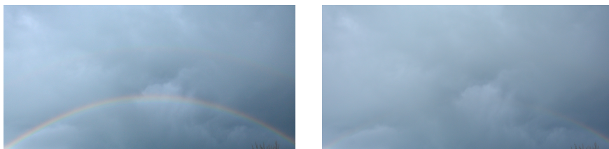
Slika 1. Fotografija mavrice skozi linearni polarizator, ki prepušča svetlobo, polarizirano v vodoravni smeri (levo), in skozi polarizator, ki prepušča svetlobo, polarizirano v navpični smeri (desno). To nakazuje, da je mavrična svetloba skoraj povsem linearno polarizirana.
